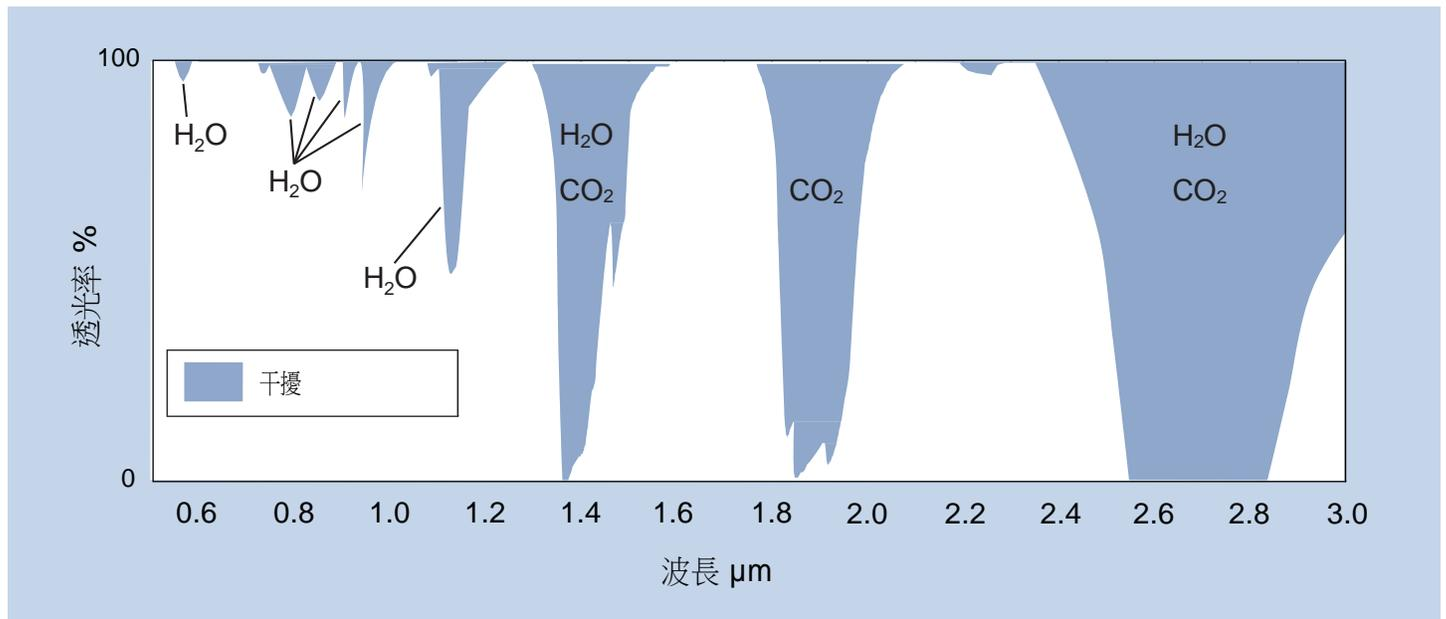
作為波長選擇的重要性的例子，可以想像一個連續熱處理爐中加熱區，保溫區和冷卻區。當 Williamson 傳感器瞄準到保溫區（其中的燃燒氣體和產品的溫度是大約相同）約 2 米，和另一品牌兩個傳感器將讀取相同的溫度值。然而當兩個
