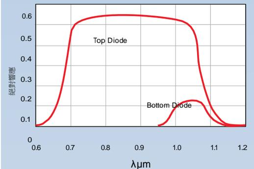
兩色檢測器的設計決定了波長設定。請注意，兩個波長重疊不經分離，1.0-1.1 μm 波長對水，蒸汽，火焰，燃燒氣體，和矽是一個錯誤的波長，以及長波長（底部檢測器）是微弱的。
